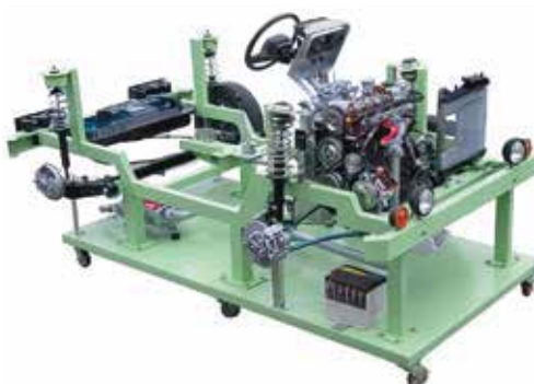
Mô Hình Ô Tô Cắt Bỏ Sử Dụng Động Cơ Xăng Truyền Động Cầu Trước
